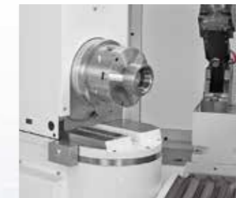
S121: Schwenkbereich +61° bis -91°
