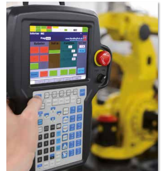
FANUC-Touchpanel mit intuitiv bedienbarer Benutzeroberfläche
