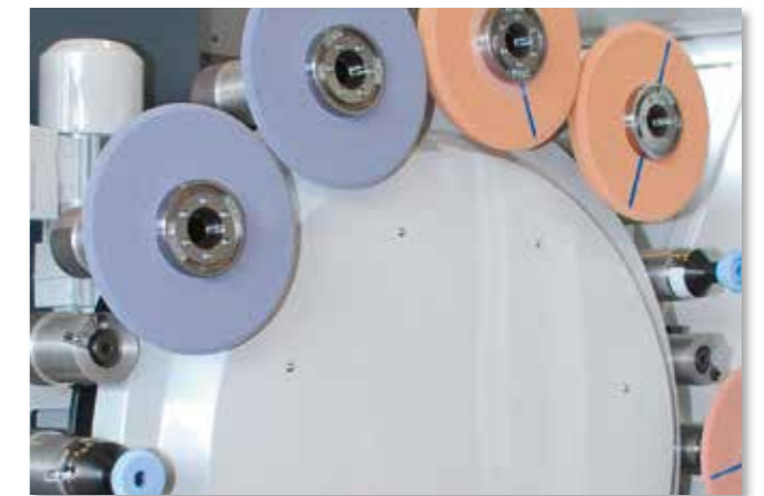
Schneller Werkzeugwechsler: Schleifen, Drehen, Fräsen, Bohren
