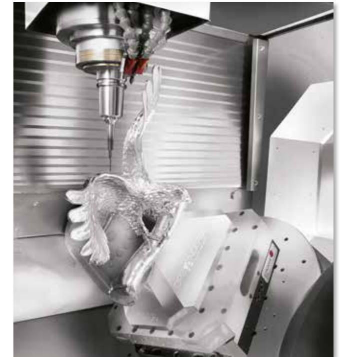
5-Achsbearbeitung mit bis zu 500 kg Werkstückgewicht
