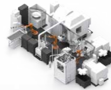
ROBOTERANLAGEN 3x 6-Achsen im Einsatz mit Reinigungs und Messstationen
