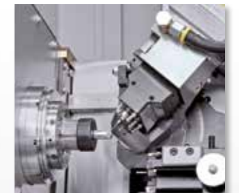
DoLittle: mit linearem Werkzeugaufbau
