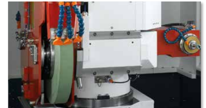
S41: Schleifspindelstock mit über 30 Grundvarianten
