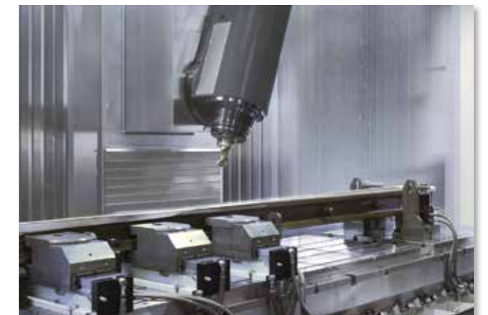
Schwenkspindel im Einsatz, Schwenkbereich +/- 100°
