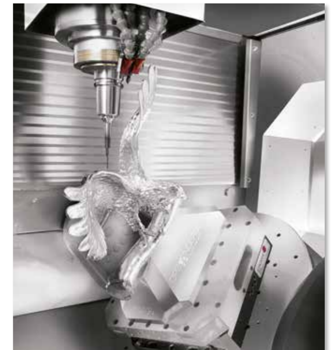
5-Achsbearbeitung mit bis zu 500 kg Werkstückgewicht
