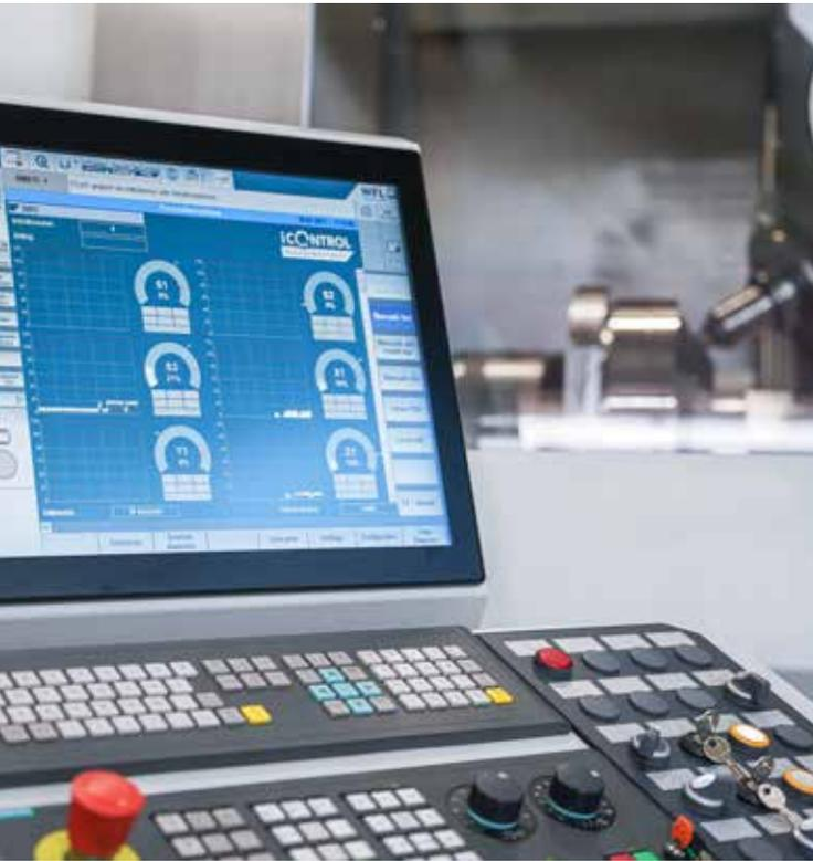
Die für die Bearbeitungsaufgaben perfekt angepasste Sinumerik 840D sl verfügt nicht nur über die höchste Rechnerleistung, sondern ermöglicht neben der besonders benutzerfreundlichen Programmierung auch das perfekte Zusammenspiel mit allen gängigen CAD-CAM-Systemen. Via LAN können NC-Programme, Technologiedaten, Messprotokolle, Werkzeugdaten und Magazinbelegung jederzeit übertragen werden.
