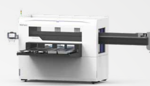
Schnell umrüstbare Bandzelle für Futterteile
