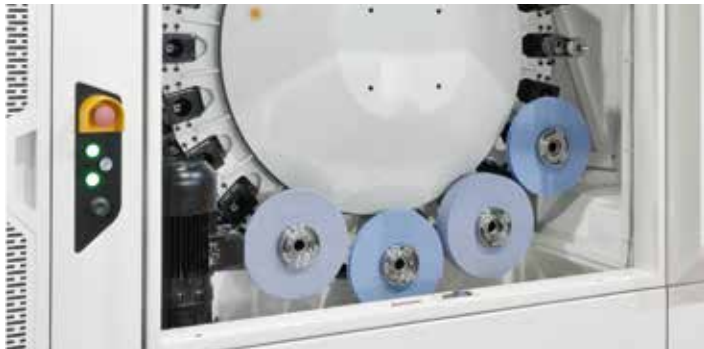
MFP 50: Werkzeugmagazin mit 24 Positionen
