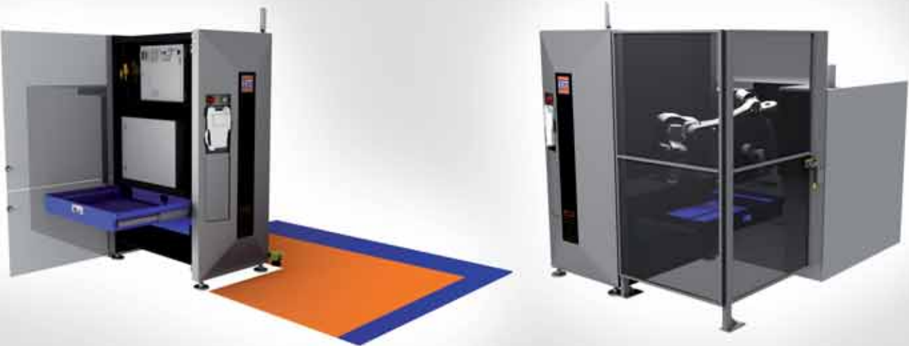
Optionale Be- und Entladung bei laufender Automation
