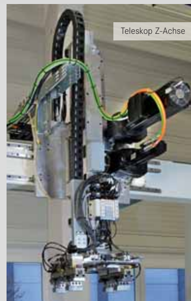
lineX zur Be- und Entladung einer Schleifmaschine
